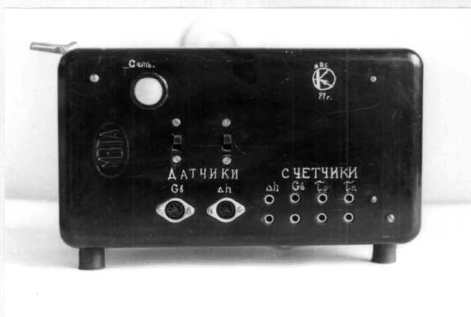
Рис.4.8. Усилитель сигналов фотодатчиков оборотов: а - принципиальная схема; б- общий вид
