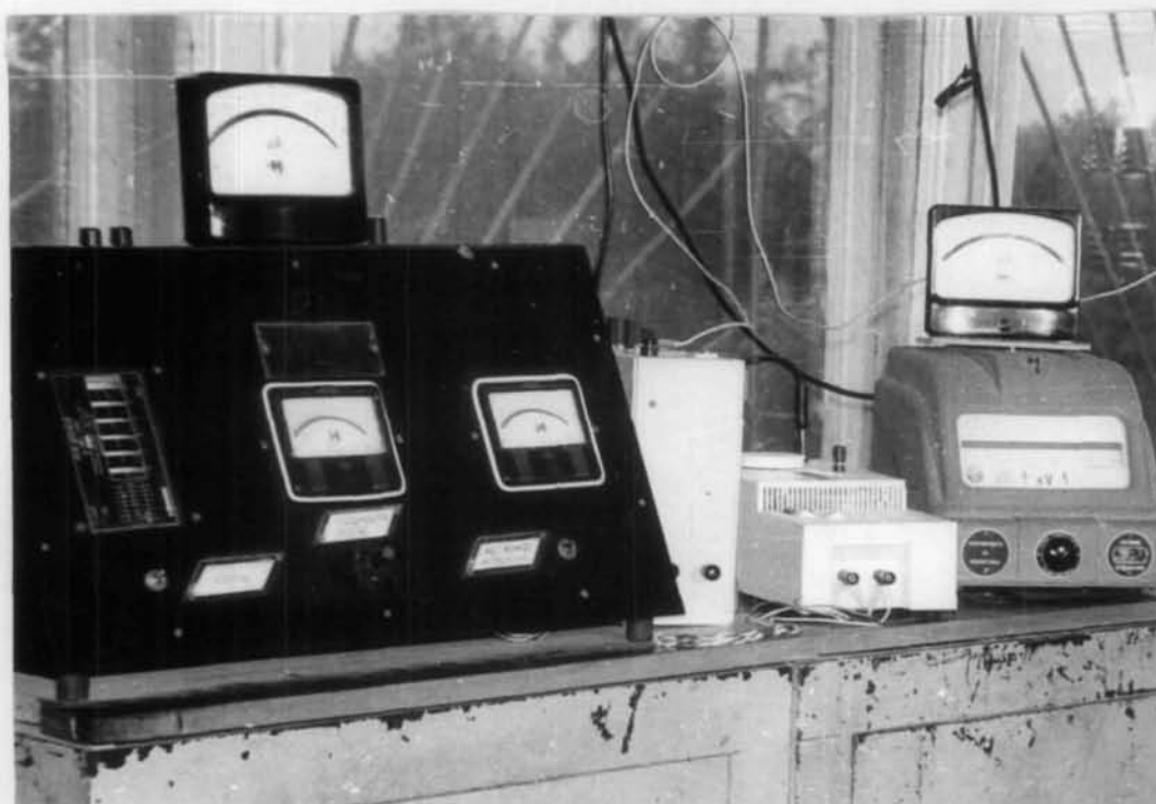
Рис. 4.II. Аппаратура для создания электрического поля высокого напряжения: а — принципиальная схема источника высокого напряжения; б — общий вид источников и киловольтметра
